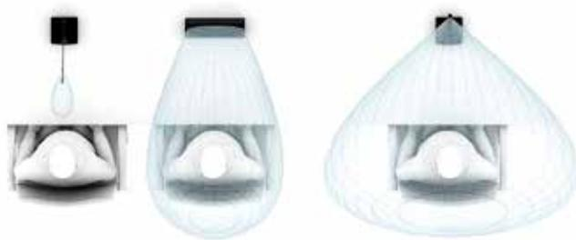
Área de captación de un micrófono de flexo comparado con un micrófono de array horizontal o vertical.
