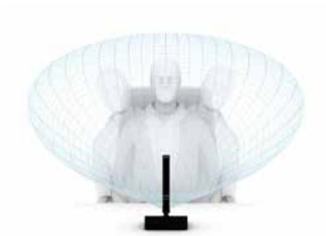
El alineamiento vertical del array resulta en un patrón de pasillo horizontal, que permite una libertad de movimientos máxima hacia izquierda y derecha sin grandes fluctuaciones de volumen. La atenuación del sonido que llega de arriba o de abajo limita la captación de señales y ruidos que llegan del techo o de la mesa.
